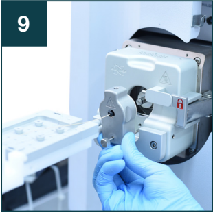
9 将色谱柱加热器从 CaptiveSpray 离子源前移开。
