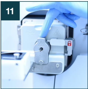
11 用戴上手套的手指堵住进气口，并监测前级压力。前级真空需要在 10 秒内降至 3e-01 mbar 以下才算可用。
