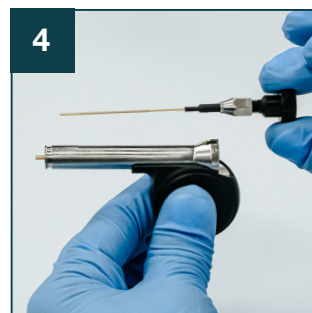
4 如图所示，握住连同运输保护塞的色谱柱。
