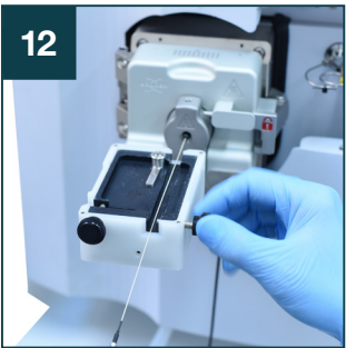
12 将色谱柱加热器移至 CaptiveSpray 离子源前方。
