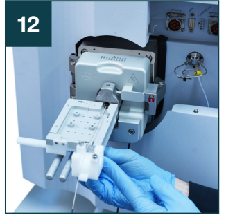
12 将色谱柱加热器移至 CaptiveSpray 离子源前方。
