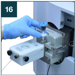
16 将过滤器安装在 CaptiveSpray 离子源的进气口。 至此，色谱柱已安装在色谱柱加热器中，准备就绪可供操作。
