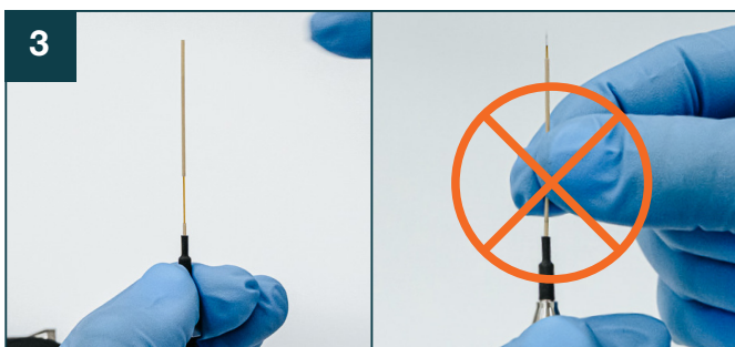
3 取出 Aurora 5 cm Rapid 色谱柱，并确保米色保护套正在保护喷针。
