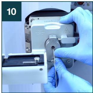
10 将 CSI 壳体插入离子源，稍加用力推入，然后将螺丝用手拧紧。
