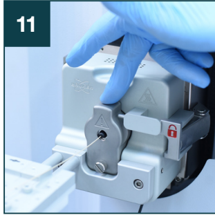
11 用戴上手套的手指堵住进气口，并监测前级压力。前级真空需要在 10 秒内降至 3e-01 mbar 以下才算可用。（如果未能密封，请在更换橡胶密封圈之前尝试重新安装）
