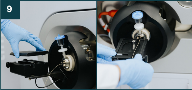
取下色谱柱加热器的盖子，在将色谱柱穿过加热器凹槽的同时，将色谱柱加热器滑动到 CaptiveSpray 离子源的前方。
