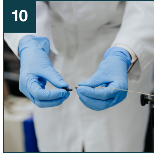
从 nanoZero® 接头上取下运输保护塞。
