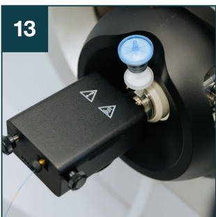
盖上色谱柱加热器的盖子。
