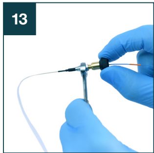
13 用扳手夹住 nanoZero® 接头，然后用手拧紧 nanoViper™ 接头，直到拧不动为止。
