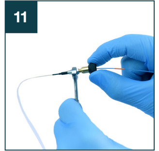
用扳手夹住 nanoZero® 接头，然后用手拧紧 nanoViper™ 接头，直到拧不动为止。
